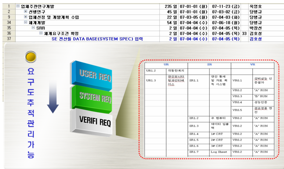
<그림 4-13>은 사용자 요구사항, 시스템 요구사항, 검증 요구사항 간에 추적이 가능하도록 요구사항 입력이 완성된 도표를 보여준다.
